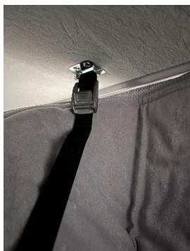
**2. D** - Beginnen Sie die Anbringung mit dem Frontteil, gefolgt von dem Heckteil und anschließend die beiden Seitenteile. Durch das angenähte Klettband kann die Isolierung direkt an das Material des Dachhimmels angeklettet werden. Achten Sie drauf, dass die Schließmechanismen sich vor der Isoliermatte befindet.
