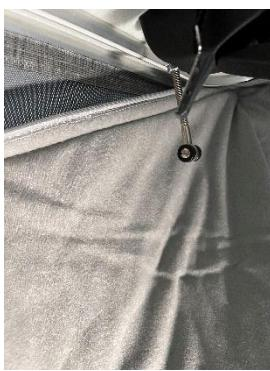
**F** - Commencez par la partie avant, ensuite la partie arrière et les parties latérales. La bande Velcro permet d'attacher l'isolation directement à la paroi intérieure. Assurez-vous que les mécanismes de fermetures se trouvent devant le tapis isolant.
